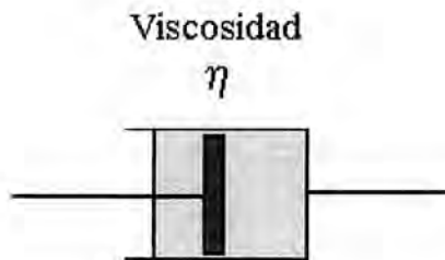
Ilustración 1.4. Amortiguador Newtoniano conteniendo un fluido con viscosidad \eta .
