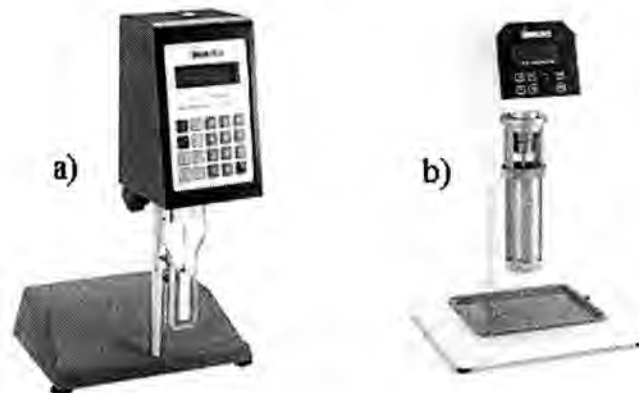
Ilustración 2.1. Viscosímetros a) Mod. DV-III ultra; capacidad de medición de 15\text{ mPa}\cdot\text{s} a 320\text{ kPa}\cdot\text{s} . b) Mod. R/S Plus Controlled Stress Rheometer con una capacidad de medición de 1\text{ mPa}\cdot\text{s} hasta 30\text{ kPa}\cdot\text{s} .
