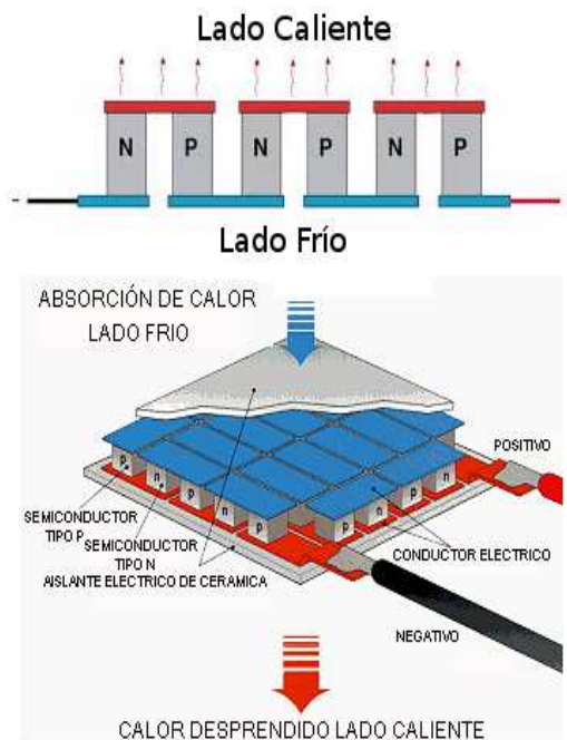
Figura 1.3: Configuración de una celda Peltier compuesta
