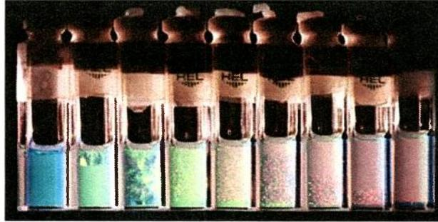
Figura 1.2: Muestras experimentales de las fases de una suspensión de esferas duras.
