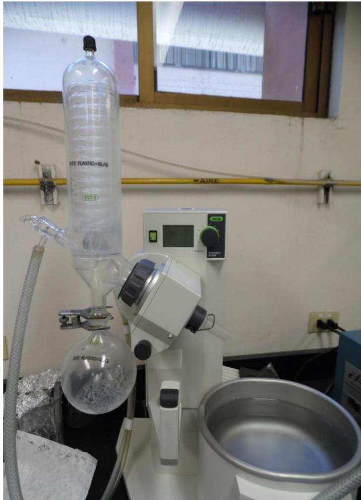
**Figura 3.3** Sistema de evaporación a presión reducida.
