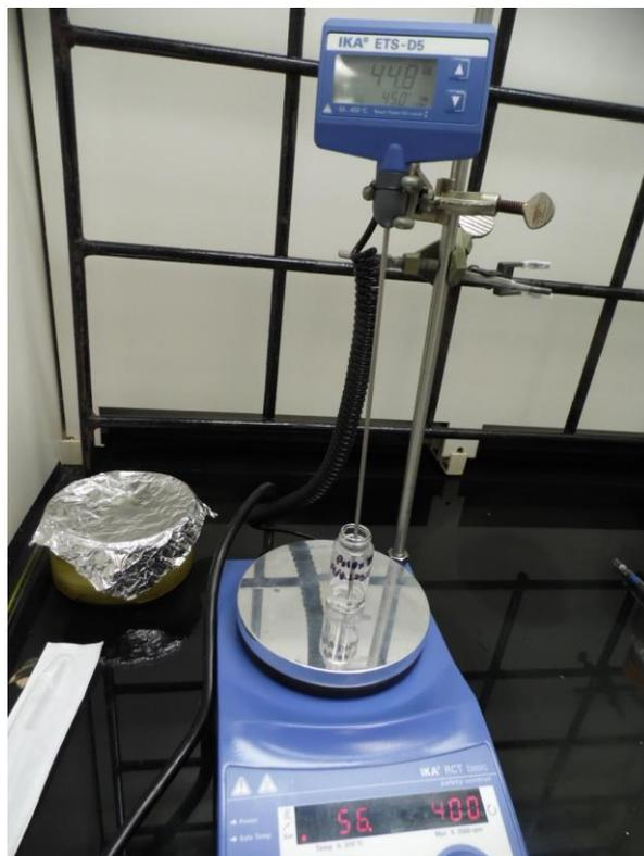
**Figura 3.2** Sistema de precipitación con control de temperatura y agitación.
