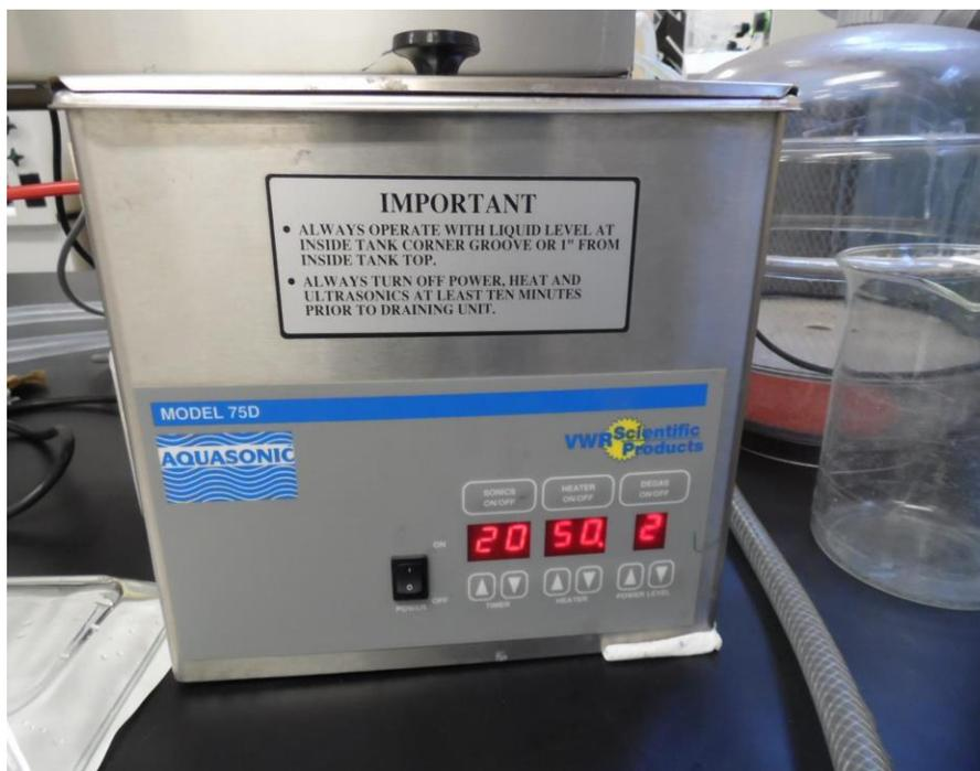
**Figura 3.1** *Sonicador marca VWR, modelo 75D, programado para sonicar por 20 minutos con baño térmico con temperatura de 50°C.*
