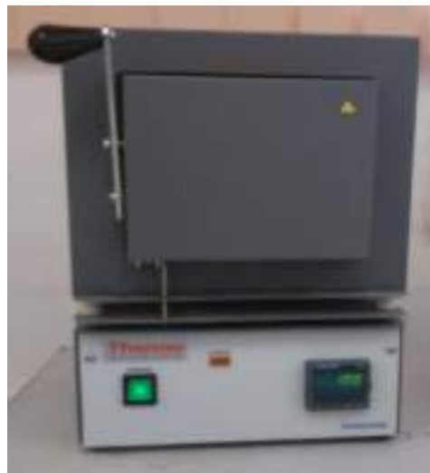
Figura 16. Horno empleado para el tratamiento térmico de las películas multicapa de ZnO.
