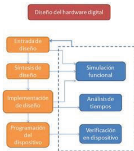
Figura 3.7 Flujo de diseño digital.
