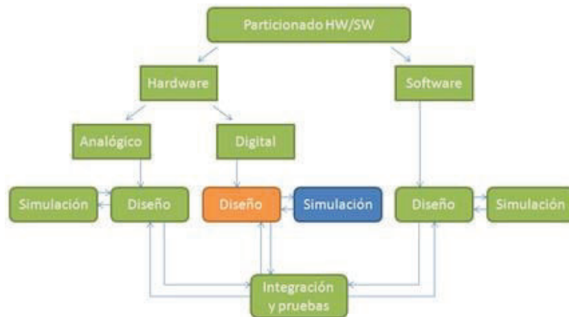
Figura 3.6 Flujo de un dispositivo Electrónico.
