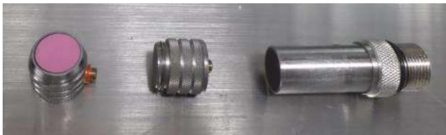
Figura 4.1: Transductores piezoeléctricos longitudinales empleados en las mediciones ultrasónicas, de izquierda a derecha: CHF104 (10MHz), TAB104 (10MHz) y V303 (1MHz).
