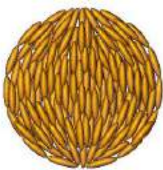
Imagen 1.1: Modelo de partícula ópticamente anisotrópica. Imagen tomada de [8]
