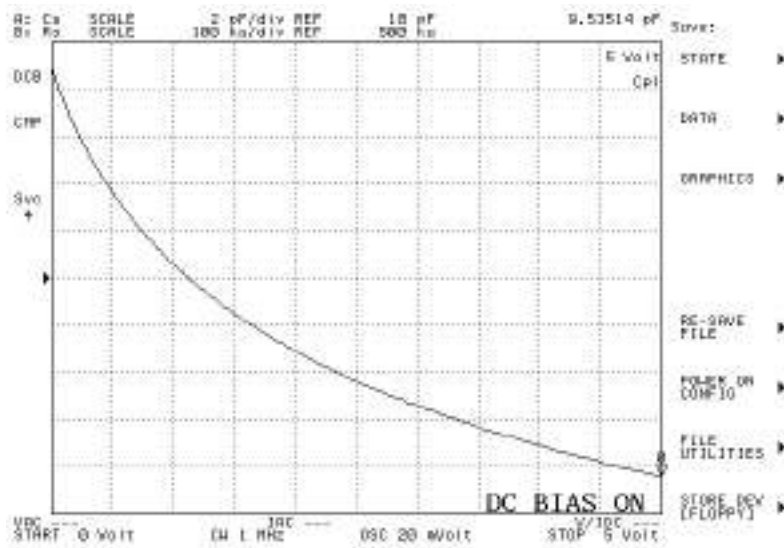
Figura 4.4. Características C-V de varactor.
