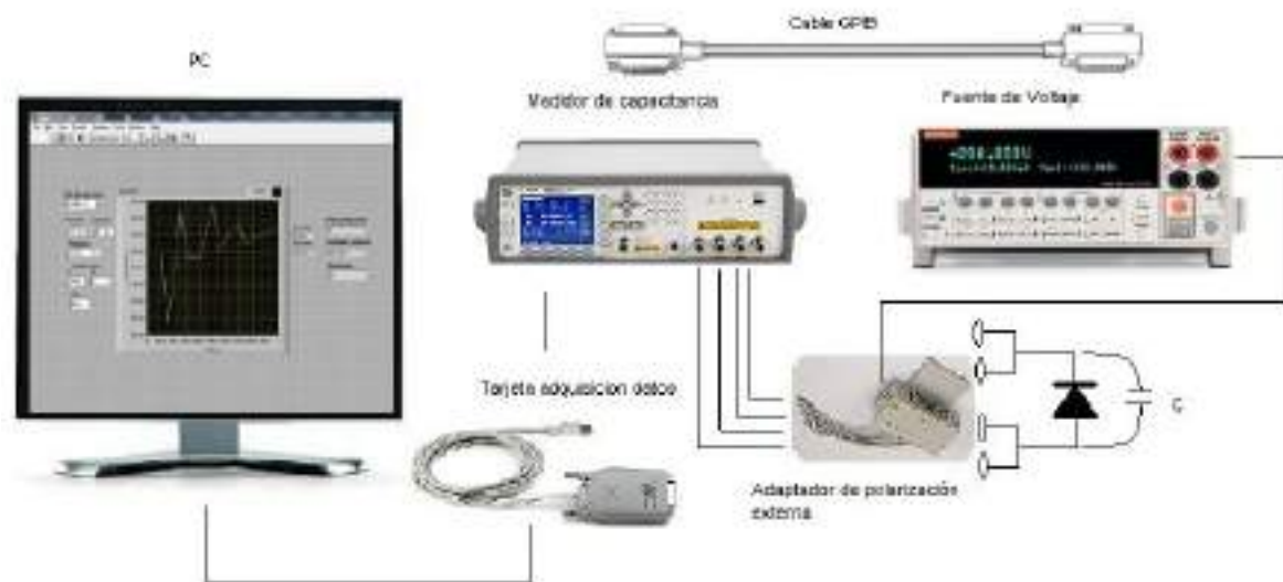
Figura 3.9. Arreglo experimental para la adquisición de datos
