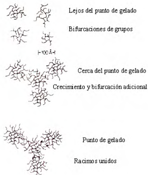
Figura 1.7. Crecimiento polimérico y la formación del gel en sistemas con catalizador base.
