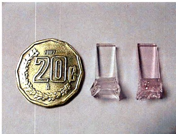
Figura 6.1.b) Imagen comparativa dimensional de los vidrios sol-gel obtenidos.
