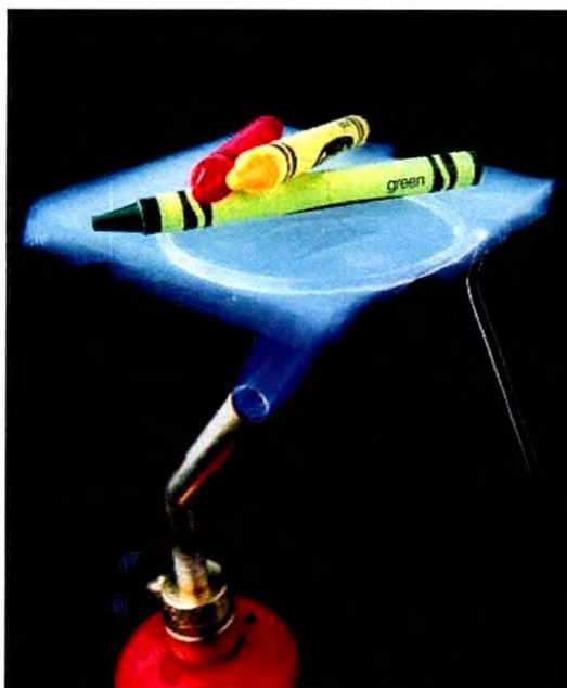
Figura 1.5. Aerogel en contacto con una llama y unas crayolas sobre este. La exposición de la llama directamente en el Aerogel protege del calor y conserva su forma.
