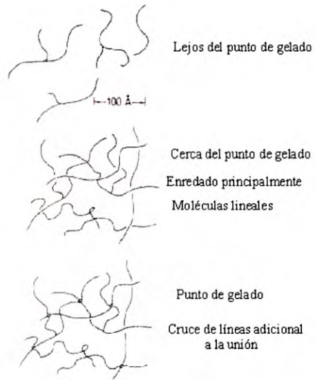
Figura 1.6. Crecimiento polimérico y la formación del gel en sistemas con catalizador ácido.
