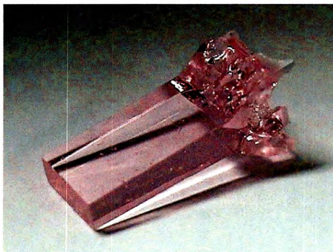
Figura 6.2. Transparencia y homogeneidad una muestra de matriz vítrea.
