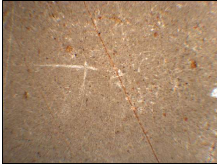
Figura 17.- Wackstone, se presenta con una tonalidad café amarillo, con vetillas rellenas de óxido de hierro, en la parte central se observa una espícula de esponja. NC 4X.
