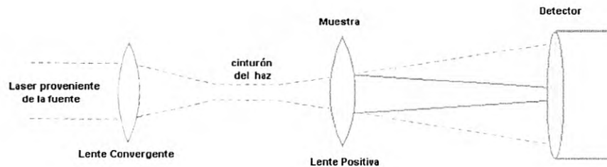
Figura 2.4. Variación de la distancia focal de la lente térmica para \frac{dn}{dT} > 0
