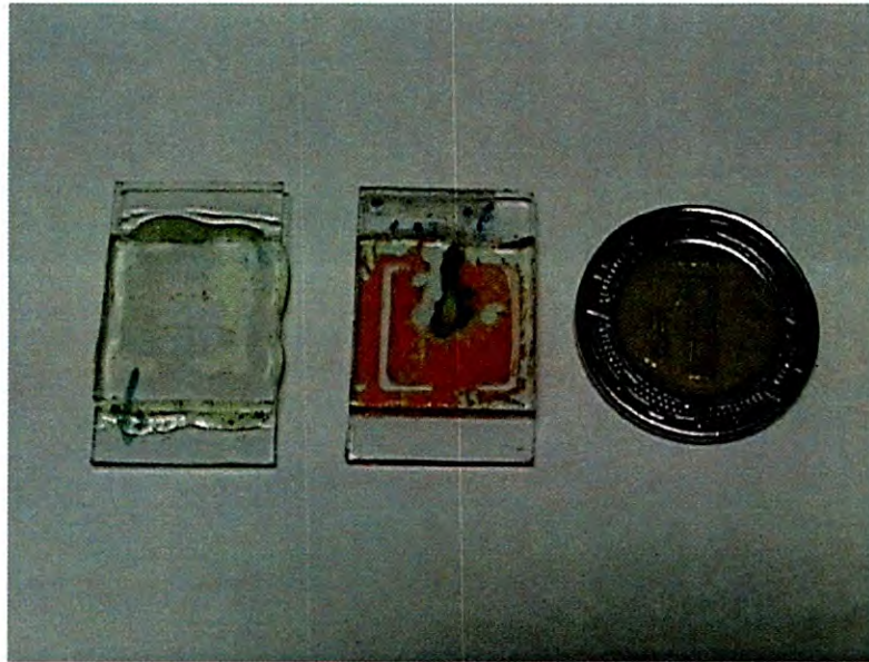
Fig. 5.1 Fotografía del CLC con y sin colorante láser comparado con un objeto conocido.
