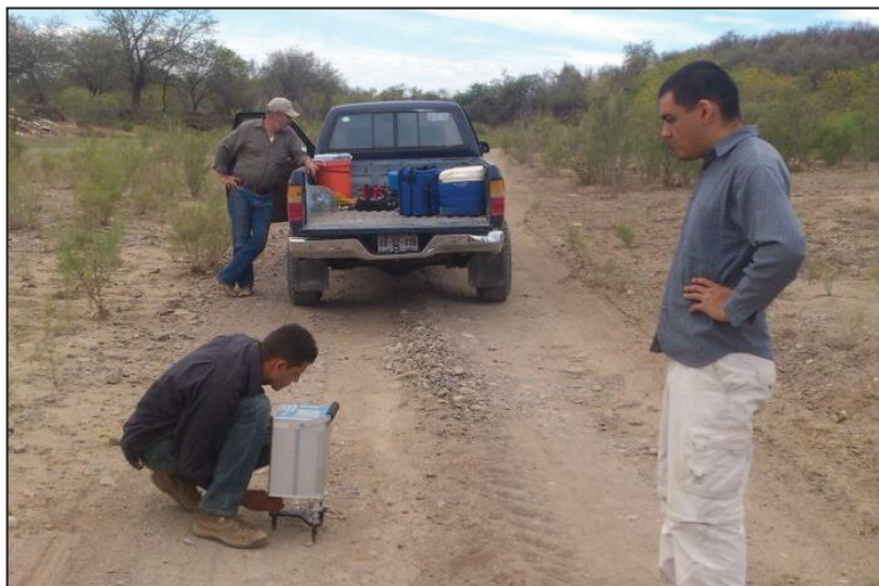
Figura 15. Medición gravimétrica a lo largo del cauce del Río Tecoripa
