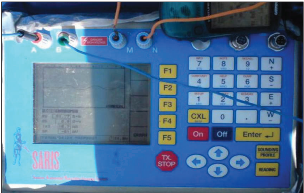
Figura 10. Vista de la consola frontal del equipo Scintrex Saris
