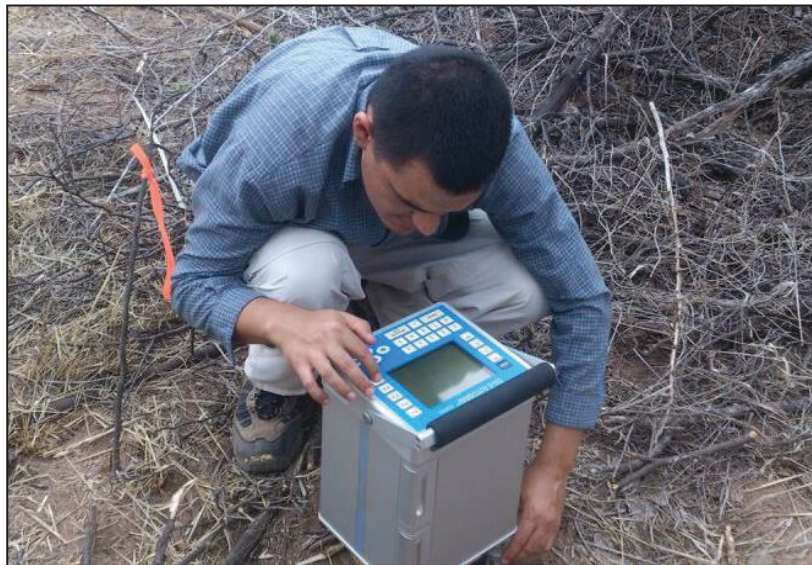
Figura 14. Realizando medición gravimétrica
