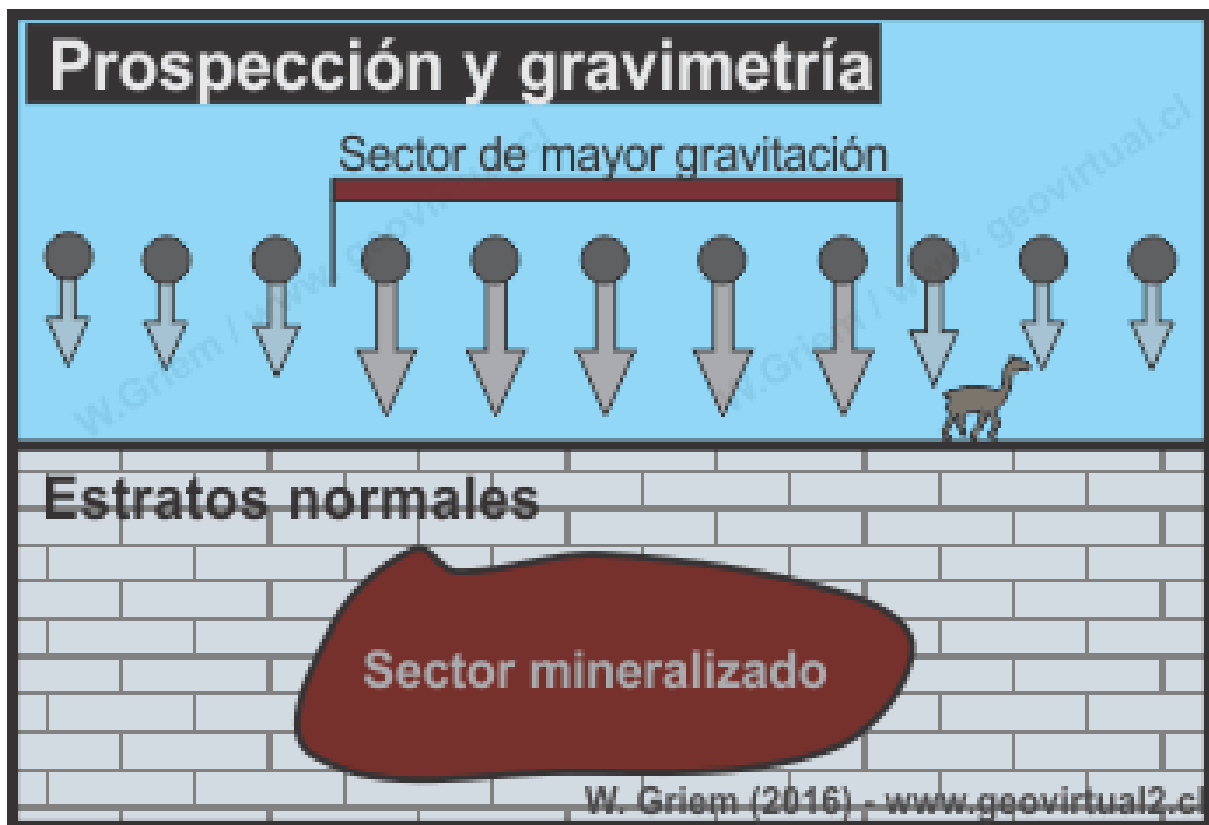
Figura 7. Descripción esquemática del funcionamiento de la gravimetría
