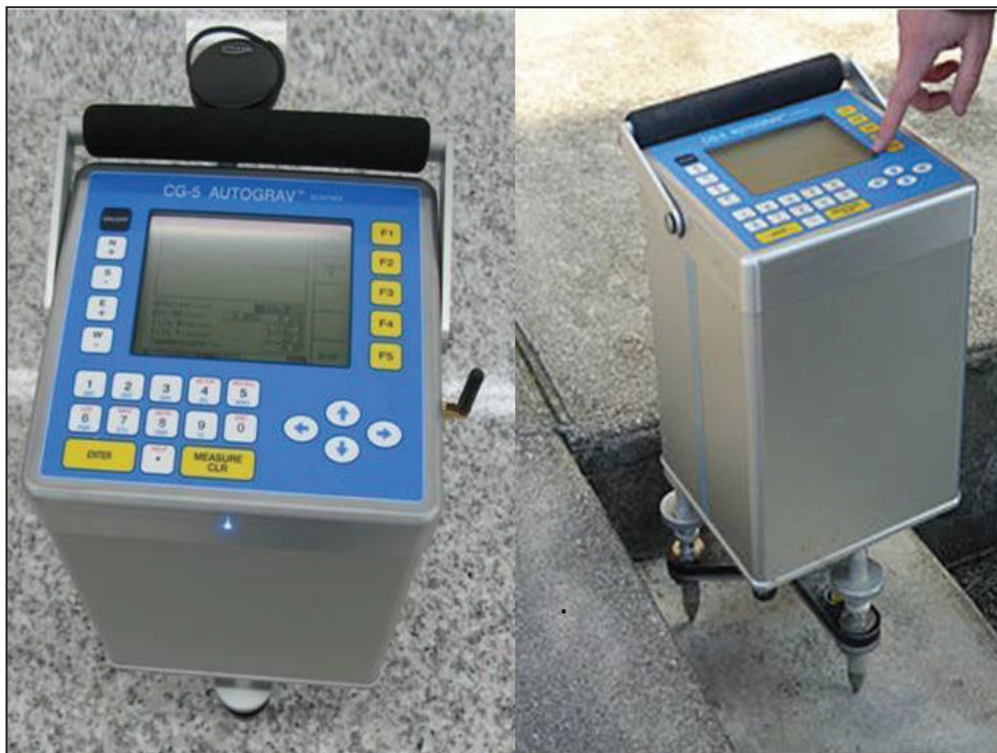
Figura 11. Gravímetro Scintrex-Autograv CG-5
