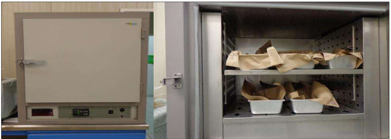
Figura 11. Secado de suelos en horno.
