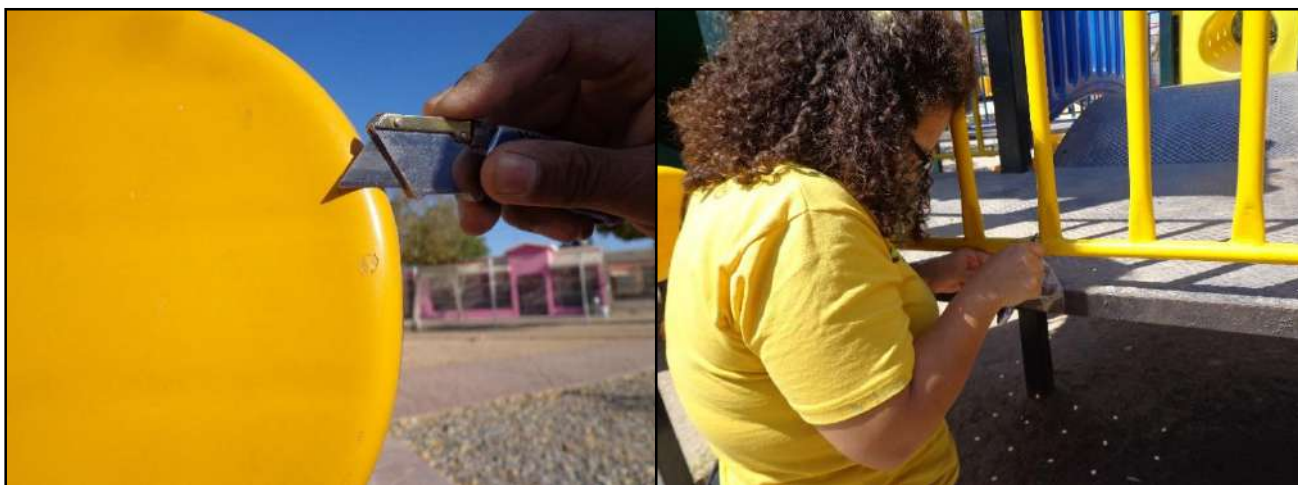
Figura 10. Toma de muestra de pintura.
