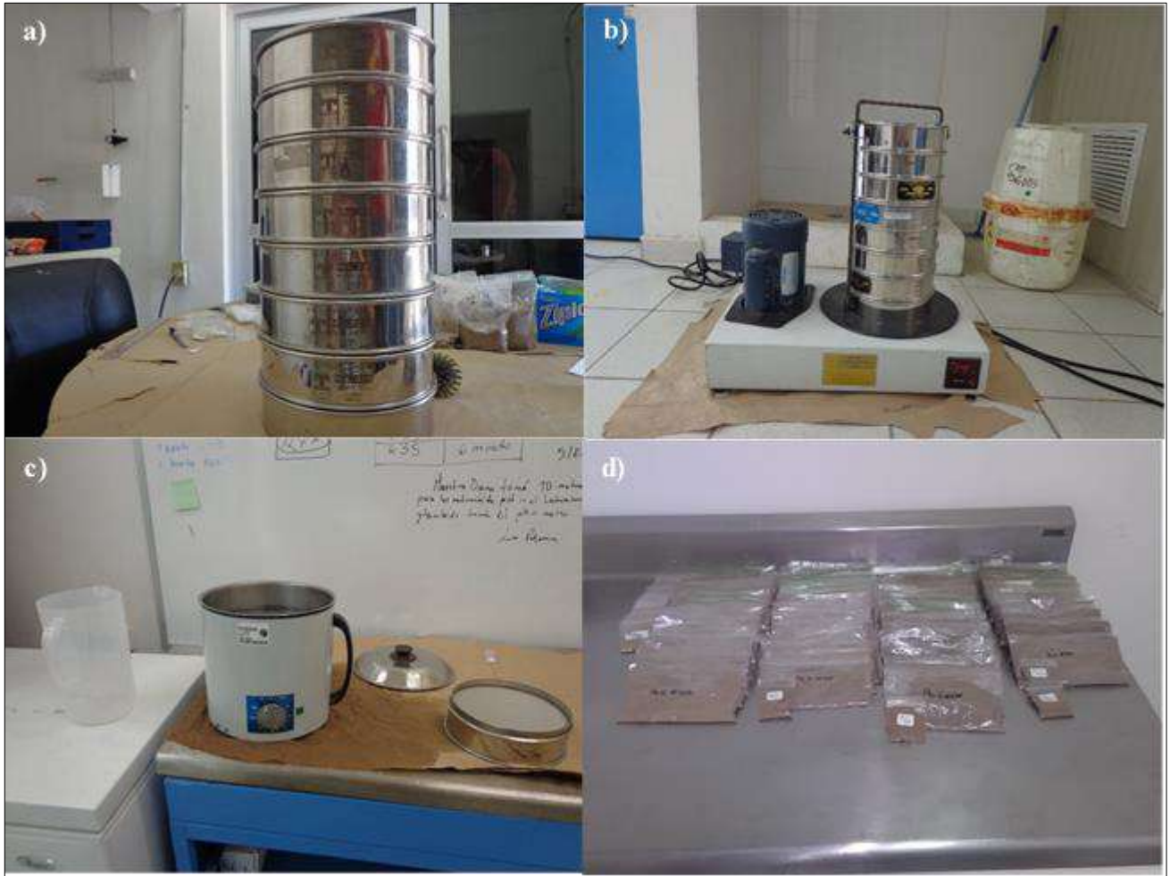
Figura 12. Tamices utilizados (a) y Ro-tap (b) para la separación de muestras de suelo en fracciones homogéneas de interés, baño ultrasónico utilizado para la limpieza de tamices (c) y resultado final de muestras tamizadas (d).
