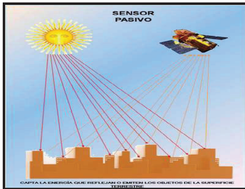
Figura 41. Sensor pasivo captando la energía que emiten los objetos en la superficie(INEGI, 2011).
