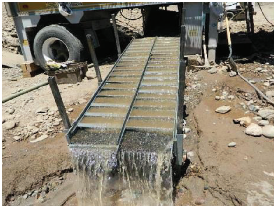
Figura 11.- Concentración mecánica con agua y canales con rifles
