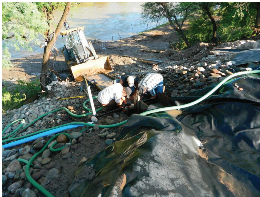
Figura 5.- Instalación de canales con rifles para el concentrado de oro
