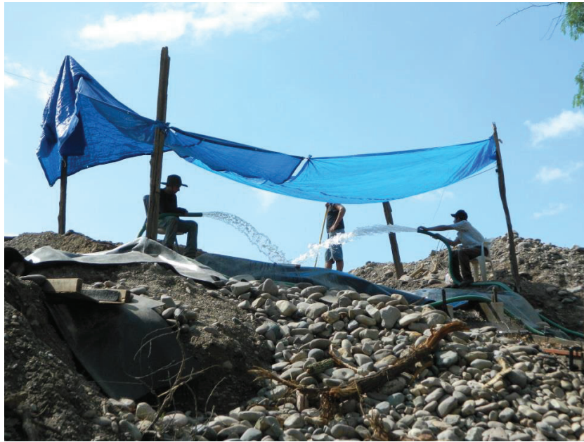
Figura 4.- Planilla de lavado de material con chorros de agua a presión
