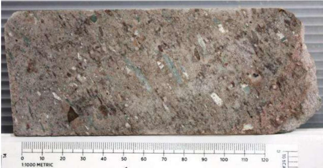
**Figura 11.** Toba de lapilli lítica ignimbrítica de composición dacítica, porfídica de feldespatos y cuarzo, de textura eutaxítica, encontrada a 116 m de profundidad mediante barrenación.
