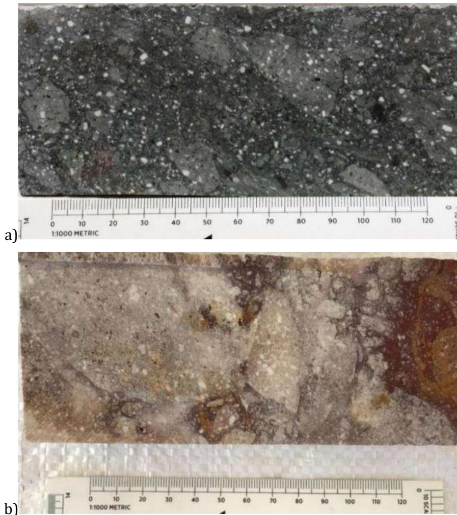
**Figura 14.** Litofacies de un flujo dacítico autobrechado. a) Muestra en la zona de sulfuros. b) Muestra en la zona de oxidación.
