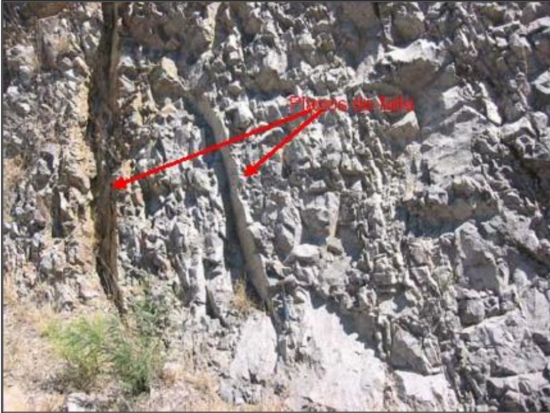
Fotografía 2.4 Fotografía tomada en Noria de Varela. Tobas andesíticas del Cretácico superior, fracturada, con estrías en los planos de falla.
