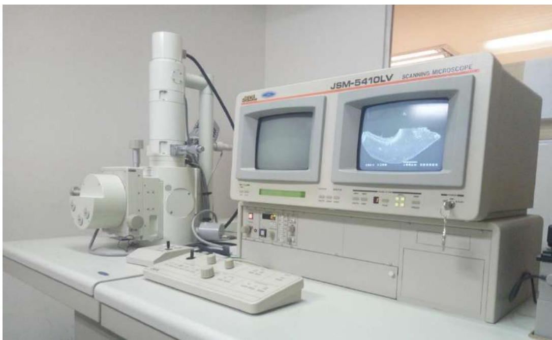
Figura 3. Toma de fotografías de elementos conodontales con MEB.
