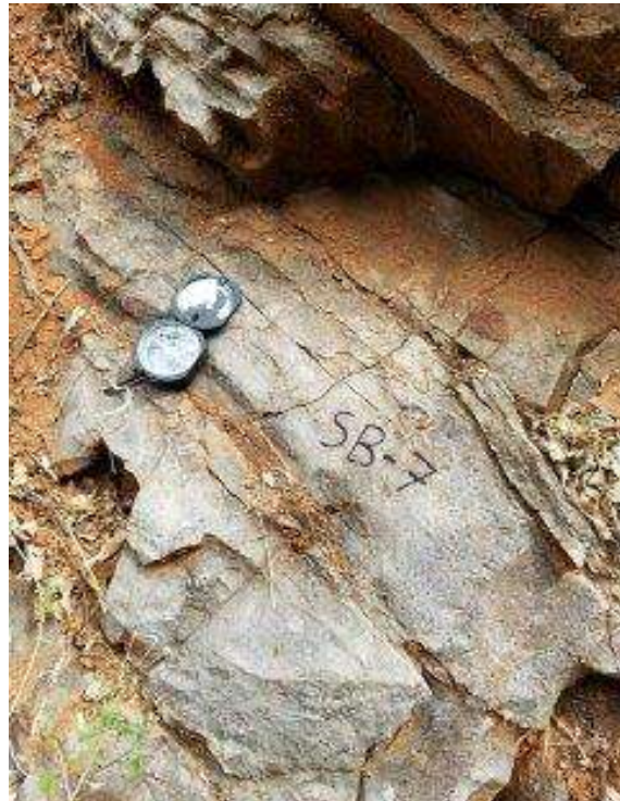
Figura 9. Afloramientos de calizas oscuras con tonos rojizos en estratos de medianos a grandes con espacios de múltiples laminaciones de color gris con fracturas rellenas de calcita.
