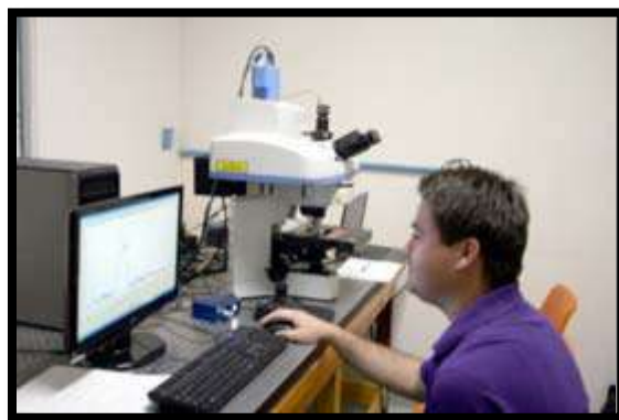
Figura 2 Espectrómetro MicroRaman Horiba Jobin Yvon que consiste de una fuente de excitación laser y detector de 1024 pixeles con un CCD de alta sensibilidad, montados en un microscopio Olympus BX41TF con resolución espacial <math><1\mu\text{m}</math>.
