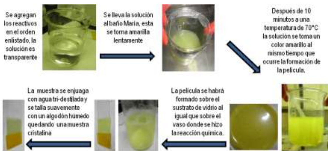
Figura 3.2. Esquema representativo del proceso químico realizado para la obtención del depósito de la película de CdS sobre el sustrato de vidrio.
