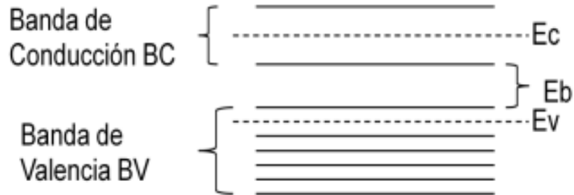
Figura 1.7. Visualización de los niveles de energía en el cálculo de las densidades de estados en las bandas de conducción y valencia.
