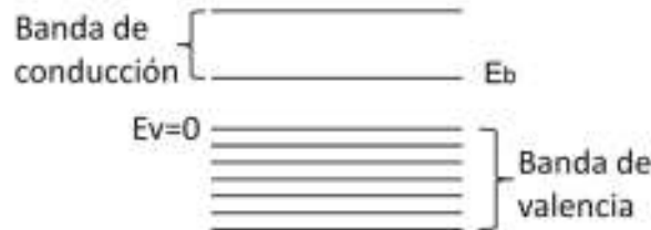
Figura 1.6. La parte superior de la banda de valencia se toma con referencia cero y la parte inferior de la banda de conducción con energía E_b .
