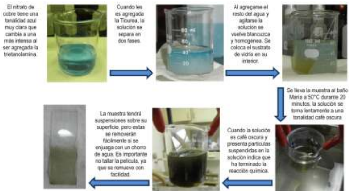
Figura 3.4. Esquema de elaboración de la película de CuS.
