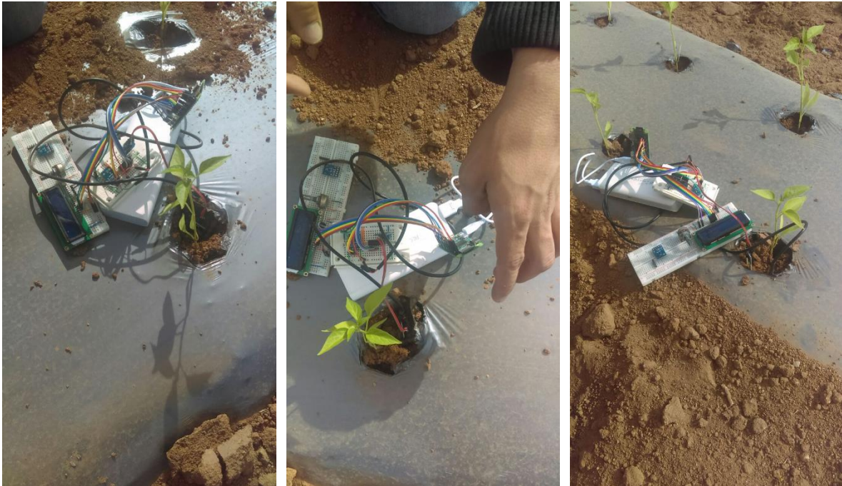
Figuras 5.12. Primeras pruebas en el campo. En la LCD se despliegan las mediciones de los sensores de temperatura, luminosidad y humedad.
