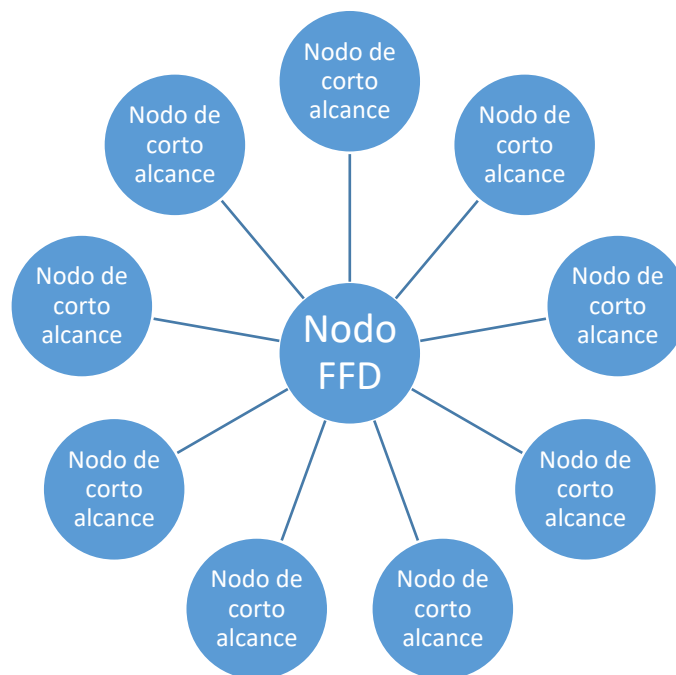
Figura 2.5. Red centralizada con 1 nodo FFD y 10 nodos de corto alcance
