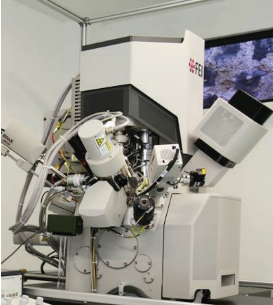
Figura 9.- Microscopio electrónico de barrido de emisión de campo con EDS utilizado para el estudio microestructural modelo SCIOS de la marca comercial FEI.
