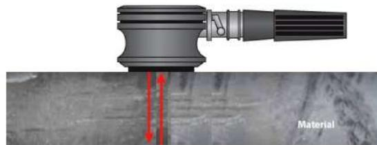
Figura 3.1: Transductor piezoeléctrico transmitiendo un pulso con incidencia normal a través de un material.
