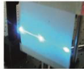
c. Patrón de difracción para una rejilla de difracción 600 líneas/mm, \lambda=457\text{nm}
