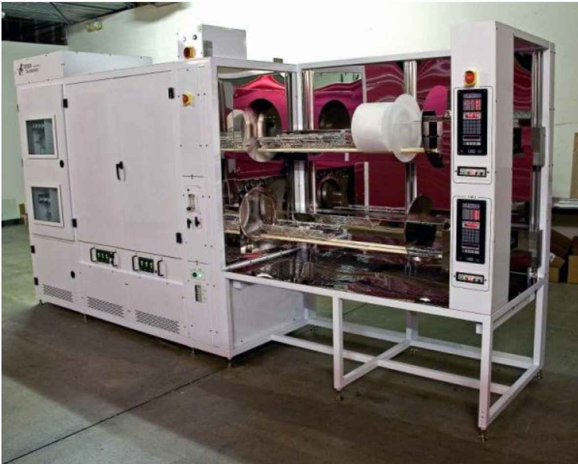
Fig. 4.1: Equipo LPCVD para la fabricación de las películas de SRO del INAOE.
