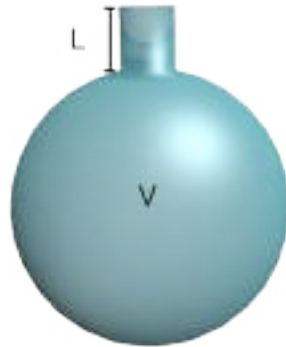
Figura 1.1: Resonador de Helmholtz.
