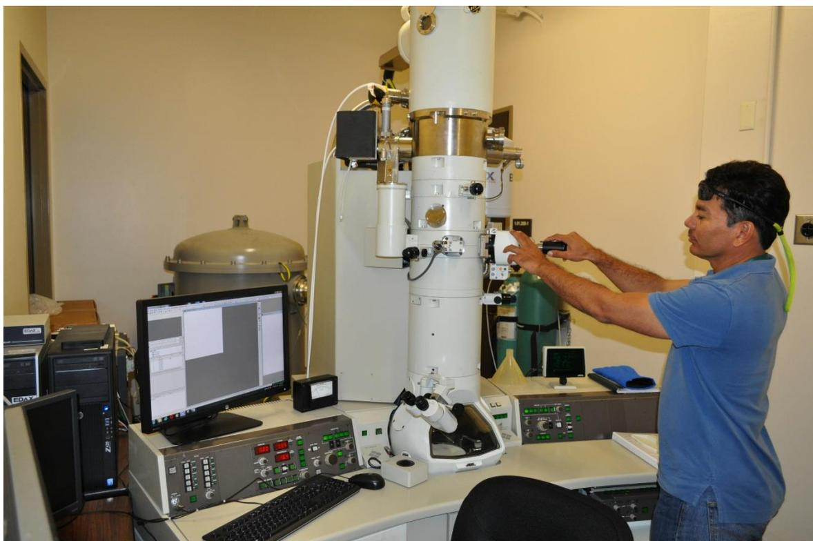
Figura 3.2.1 Microscopio Electrónico de Transmisión JEOL F2010 (Universidad de San Antonio, Texas).
