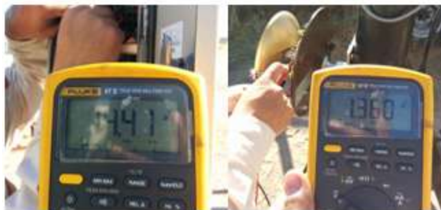
Figura 44. Voltaje en batería de receptor y voltaje en receptor.
