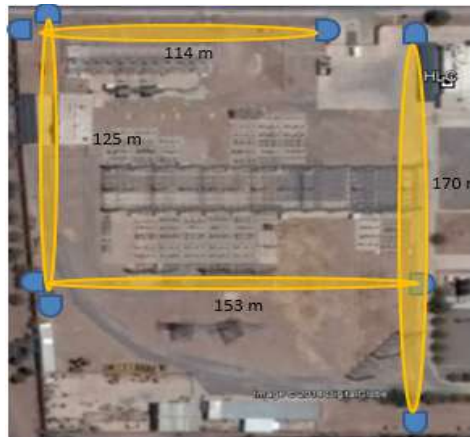
Figura 40. Área cubierta por sensores microondas en Bahías de 115 y 13.8 Kv.
