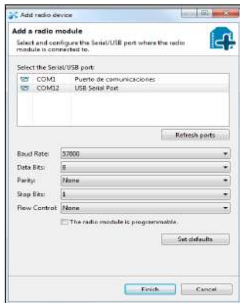
Figura 79. Configuración de parámetros en programa XCTU.
