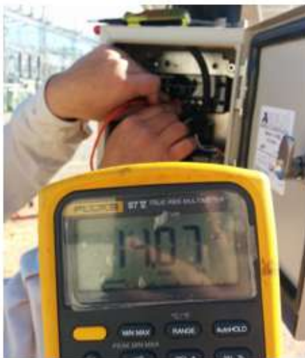
Figura 42. Voltaje en batería de receptor y voltaje en receptor.
