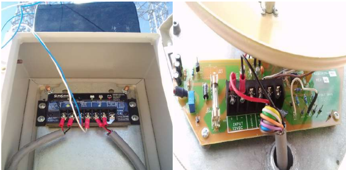
Figura 89. Conexión sensor TX.
