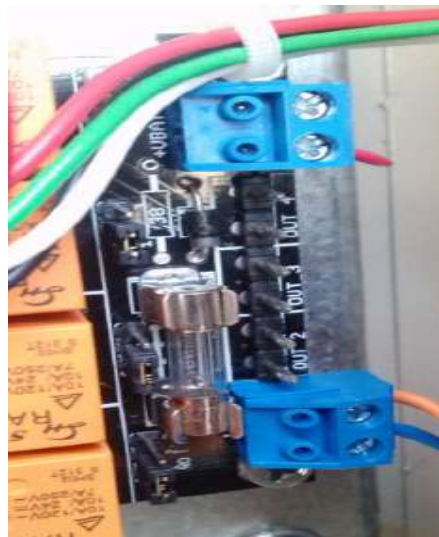
Fig. 94 Conexión RX Tarjeta CFE.
