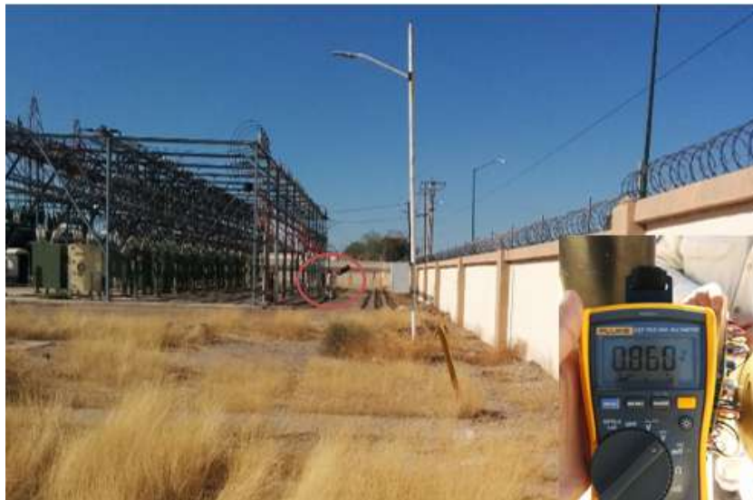
Figura 65. Voltaje de recepción enlace de 114m.
