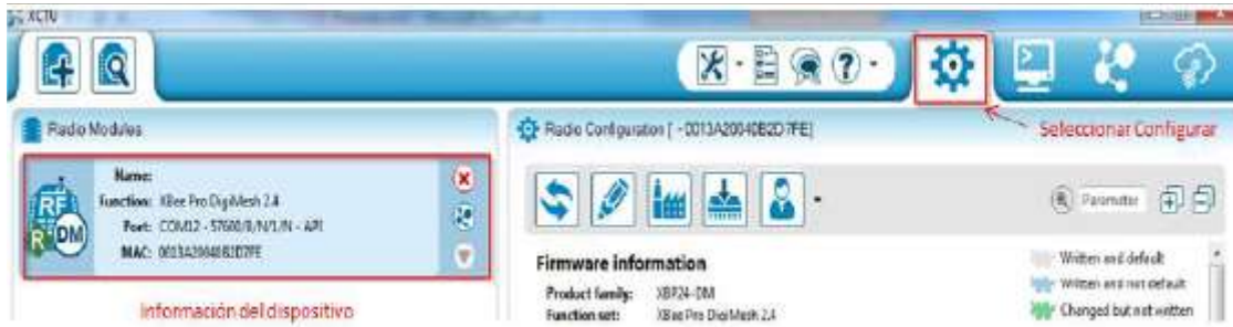
Figura 80. Configuración de XBee mediante programa XCTU.
