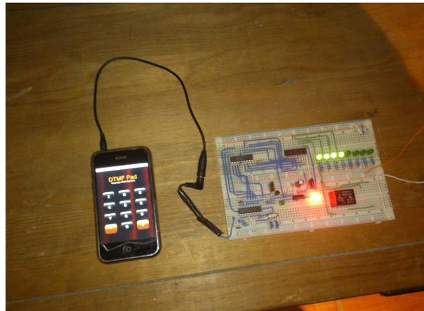
Figura 4.8: Primera prueba utilizando una aplicación que genera tonos DTMF.
