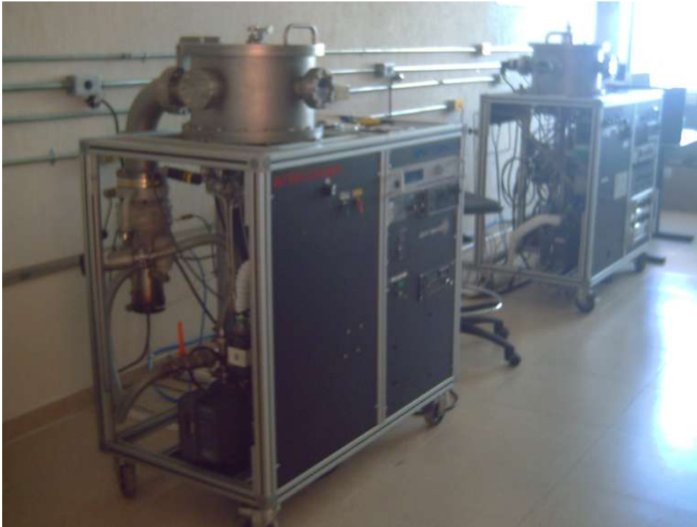
Figura 2.1 Sputtering utilizado para el depósito de aluminio y cromo en el Centro de Investigación y estudios avanzados del IPN Unidad Querétaro.
