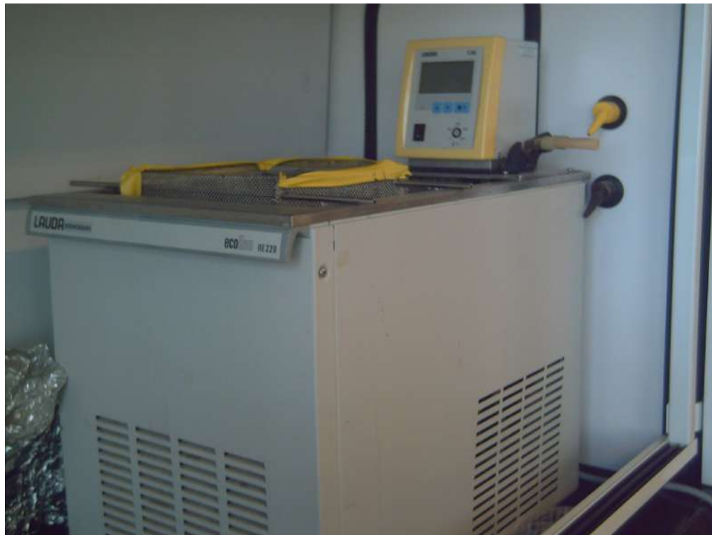
Figura 2.2 Baño químico utilizado para el depósito de películas delgadas de sulfuro de plomo en el Centro de Investigación y estudios avanzados del IPN unidad Querétaro.
