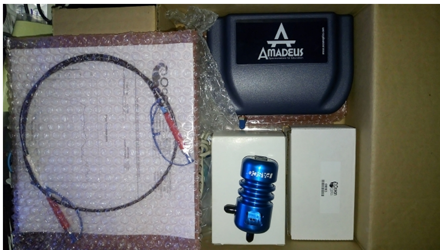
Figura 13. Espectroscopio de uso puramente didáctico. Usado para la caracterización de los LED disponibles en el mercado local.
