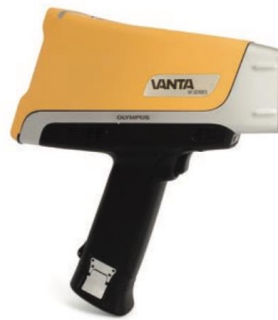
Figura 5.7. Analizador portátil de fluorescencia de rayos X (XRF) (Vanta).
