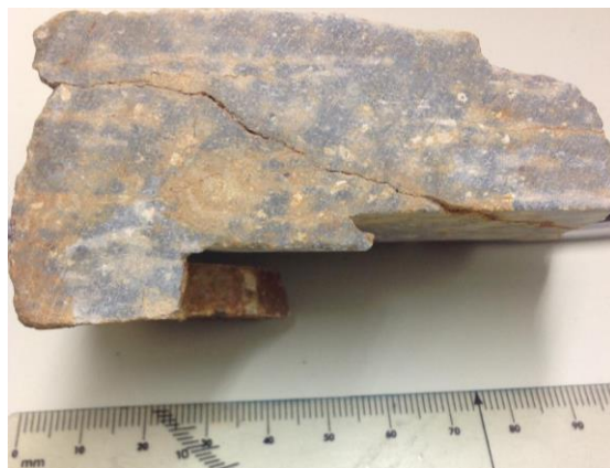
Figura 4.6. Muestra de mano JR-11, que corresponde a la Unidad Dacita. Se observa en superficie fresca un flujo laminado. Presenta fracturas irregulares rellenas de óxidos de hierro(hematita) y calcita, las cuales cortan la estructura primaria (flujo).
