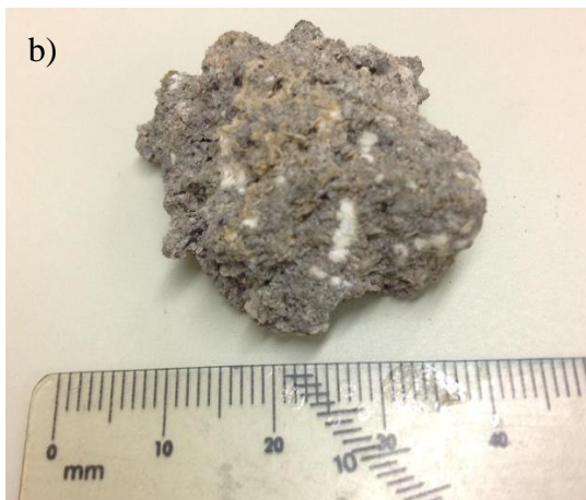
Figura 5.4. Difractograma, foto y fotomicrografía de la muestra S1 correspondiente a la unidad de suelo Material no consolidado. a) Difractograma congruente con la mineralogía de calcita y yeso en la muestra de mano S1, b) fotografía de la muestra de mano S1 mostrando cristales blancos de yeso. c) Fotomicrografía de la muestra S1 con cristales de yeso con habito laminar, perteneciente a la unidad de Material no consolidado.
