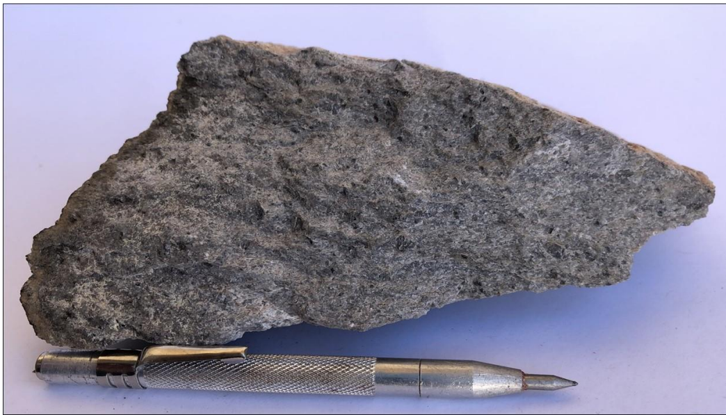
Fig. 4.3.0.- Fotografía de Metariolita fluidal afectada por fuerte silicificación e incipiente cizallamiento. Mineralógicamente está compuesta por fenocristales de cuarzo, feldespato y plagioclasas además de pirita fresca diseminada.
