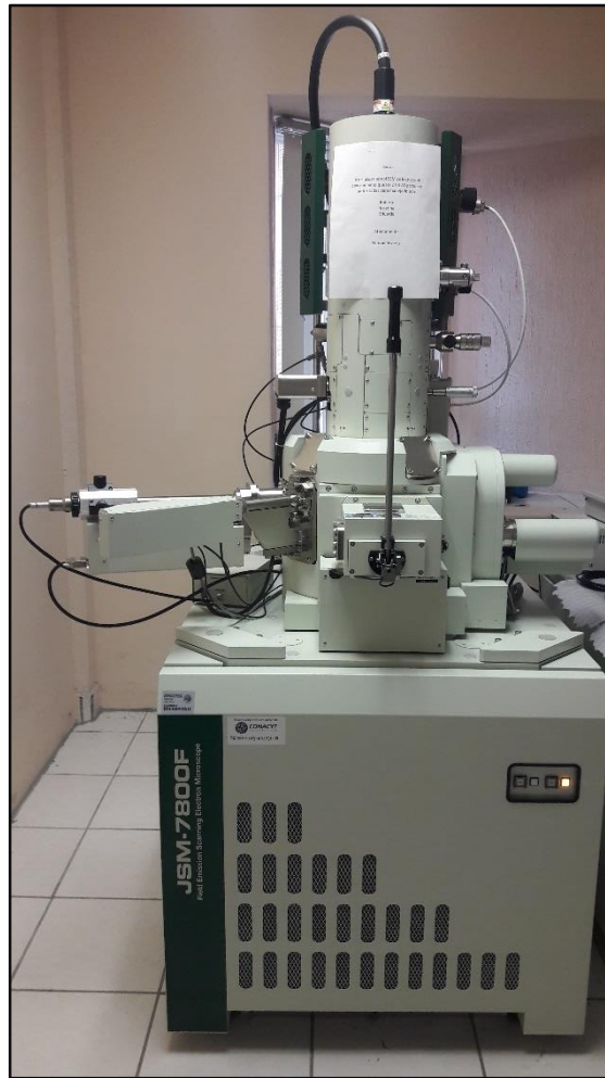
Fig. 7.1 Microscopio electrónico de barrido JEOL JSM-7800F del Departamento de Física, laboratorio de posgrado de nanotecnología de la Universidad de Sonora.
