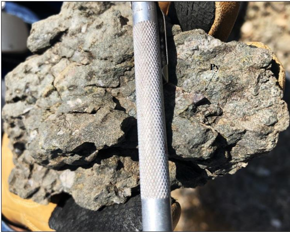
Fig. 4.4.0.- Fotografías del MVSJ-2a en donde se puede observar muestra de mano correspondiente a andesita hipocristalina porfídica de plagioclasas además se aprecia cubos de pirita oxidada. Py=pirita.
