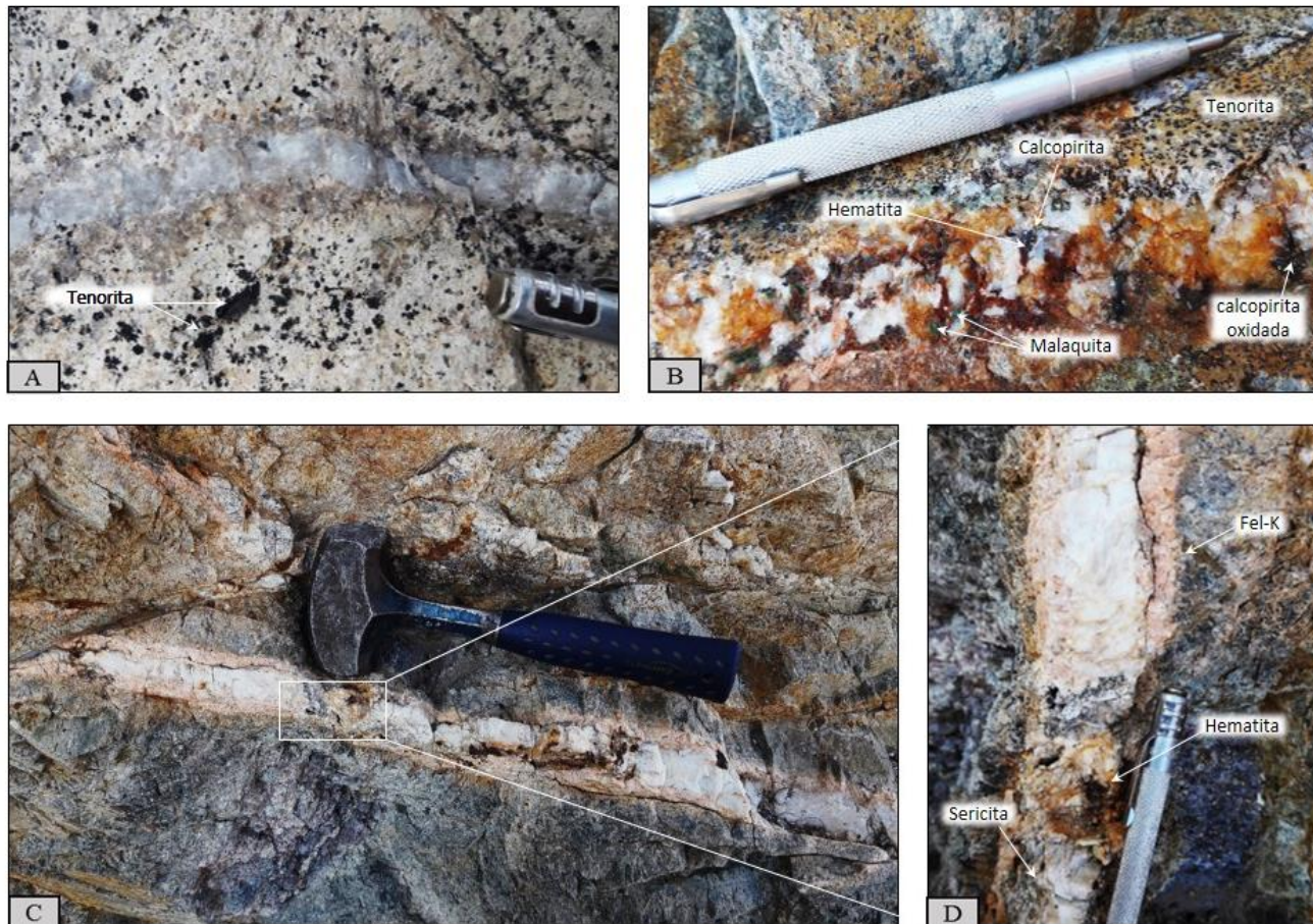
Fig. 6.1 A) Vetilla de cuarzo con halo de sericita y tenorita con mayor distribución en las orillas dentro de la roca encajonante, B) Vetilla de cuarzo de 3 cm de ancho con presencia de calcopirita parcial a totalmente oxidada, con pequeños cristales de malaquita cercanos a los cristales oxidados de sulfuros y tenorita mayormente distribuida en las orillas o fuera de la vetilla. Vetilla de cuarzo lechoso con halo de alteración de feldespato potásico, D) Acercamiento de la misma donde se observa cristales pirita de 2-5mm en tamaño, parcial a totalmente oxidada y acompañada de menor presencia de sericita y calcita, con un halo de feldespato potásico de 2-4mm. Además se observa alteración tipo fílica en la roca encajonante, ubicada en la zona SE.
