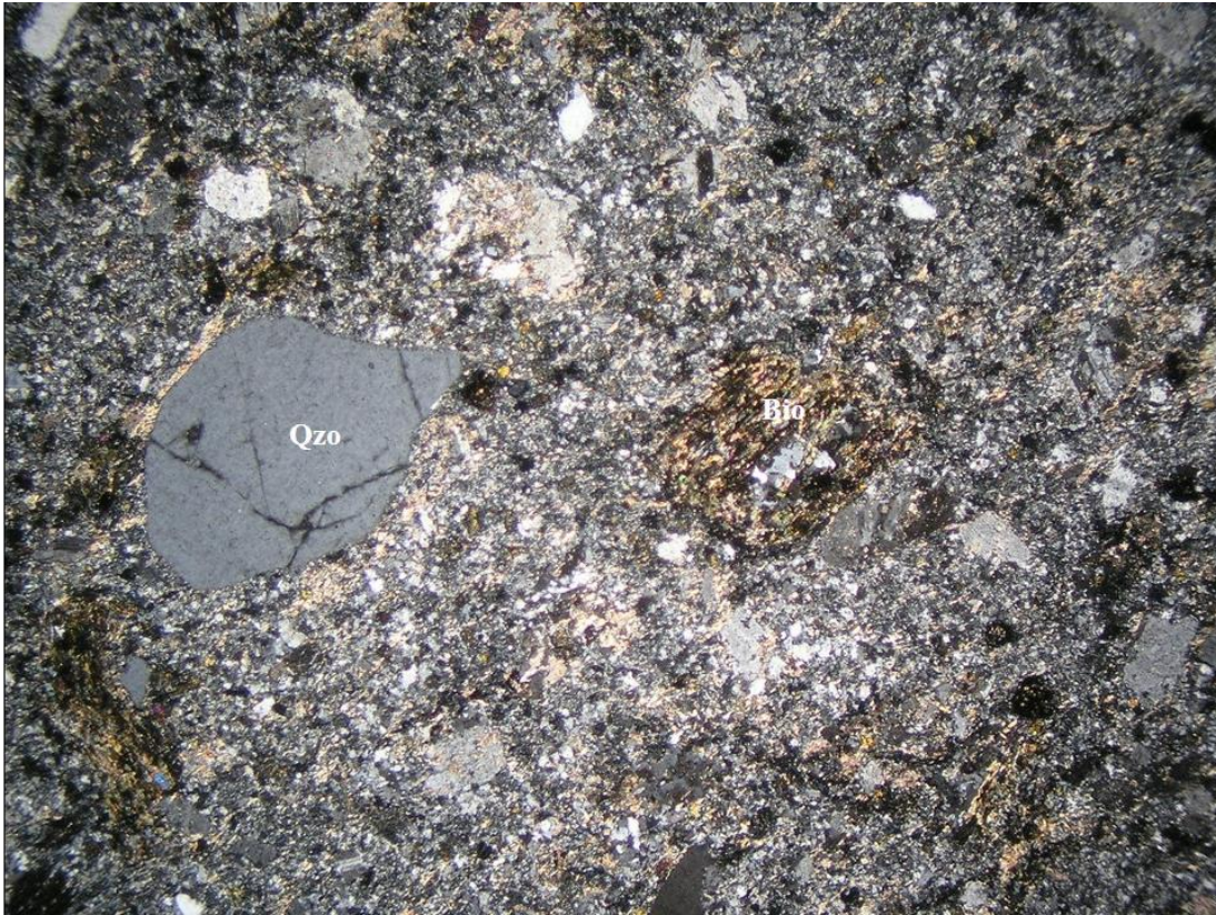
Fig. 6.8 Microfotografía de la muestra SJV-006 donde se puede observar cristales de cuarzo con bordes de corrosión ocasionados por fuerte alteración sericita y biotita metasomática; la roca presenta una fuerte silicificación en matriz e intensa alteración de sericita afectado principalmente a feldespato, plagioclasa y biotita. Qzo=cuarzo, Bio=biotita.
