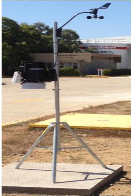
Figura 2.19 Estación Meteorológica Davis Vantage Pro 2.
