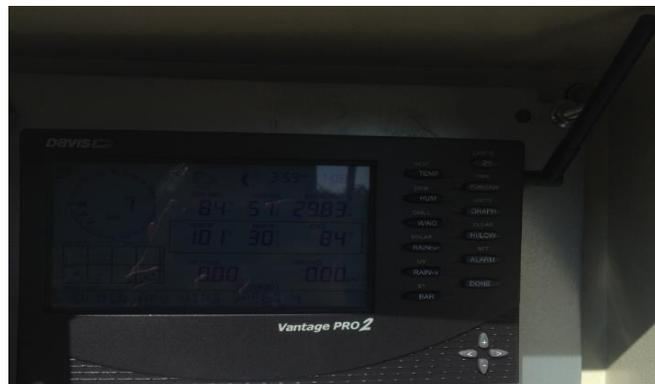
Figura 2.21 Consola para Estaciones Vantage Pro2.
