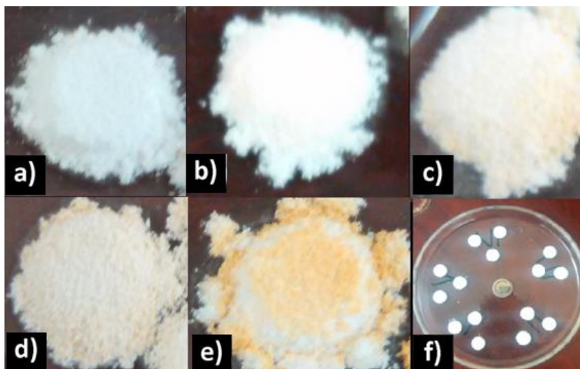
Figura 10. Materiales obtenidos de la síntesis por DVQSIH de TiO 2 con 0% (a), 0.5% (b), 1% (c), 2.5% (d) y 5% (e) de europio, además de las pastillas antes de ser sometidas al tratamiento térmico.
