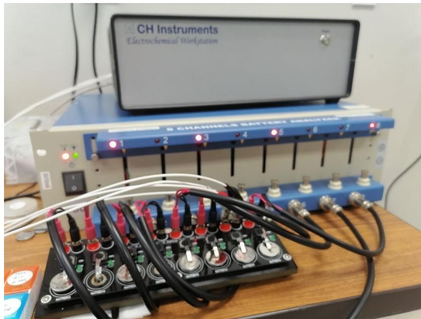
Figura 34: Equipo de caracterización para espectroscopía de impedancia electroquímica
