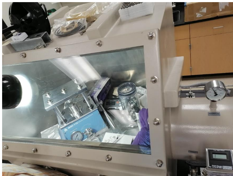
Figura 13: Cámara de argón para el ensamble de baterías
