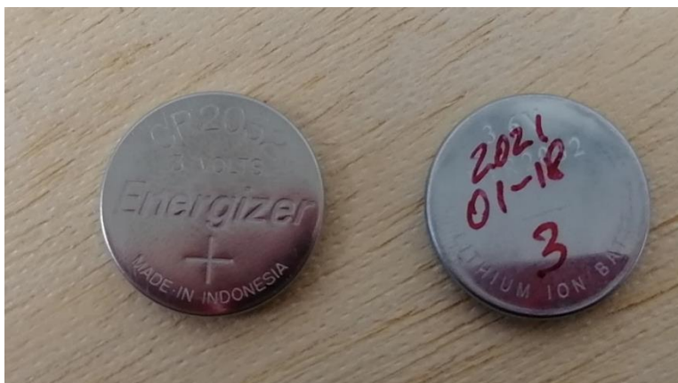
Figura 28: Batería tipo moneda comercial (lado izquierdo) VS batería construida para la investigación (lado derecho).
