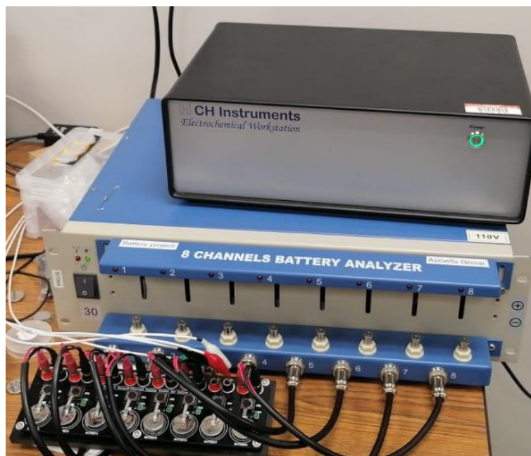
Figura 19: Posicionamiento correcto de la batería en el analizador de 8 canales
