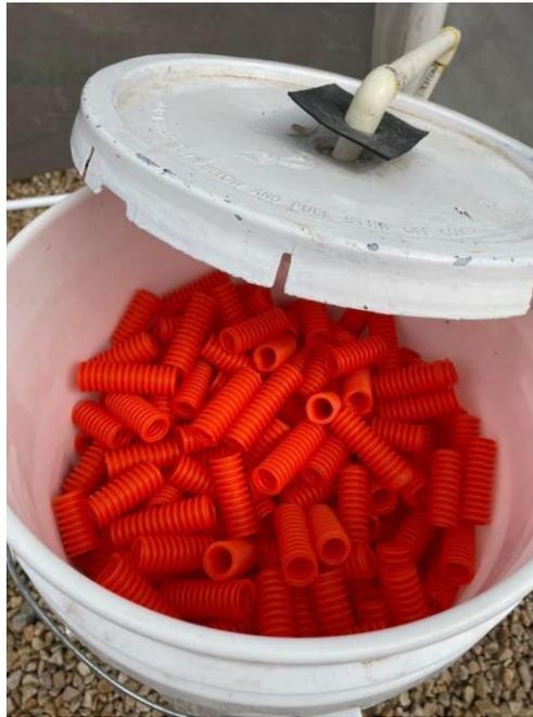
**Imagen VII. Cortes de poliducto corrugado para biofiltro de sistema acuapónico**
