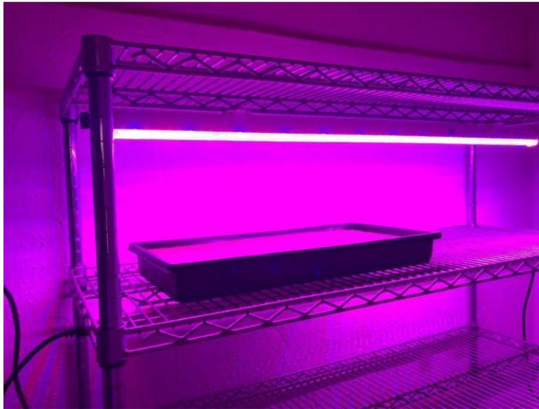
**Imagen 3.** Sistema para la germinación de lechugas en el cuarto de producción a 25°C con luz led azul y roja
