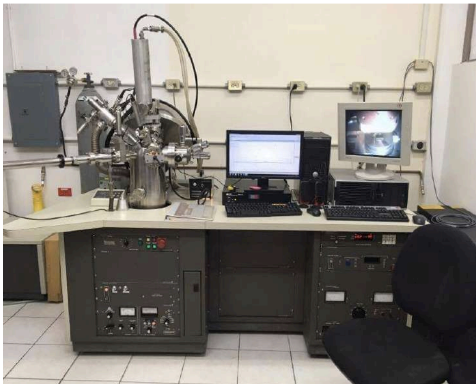
Figura 13.- Espectrómetro de Fotoelectrones Emitidos por Rayos X, marca PERKIN-ELMER, modelo PHI5100 con fuente Mg y Al, del Departamento de Investigación en Física de la Universidad de Sonora.
