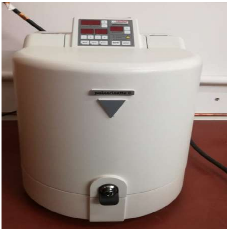
Figura 6.- Molino planetario, marca FRITSCH, modelo Pulverisette 6, del Departamento de Investigación en Física de la Universidad de Sonora.
