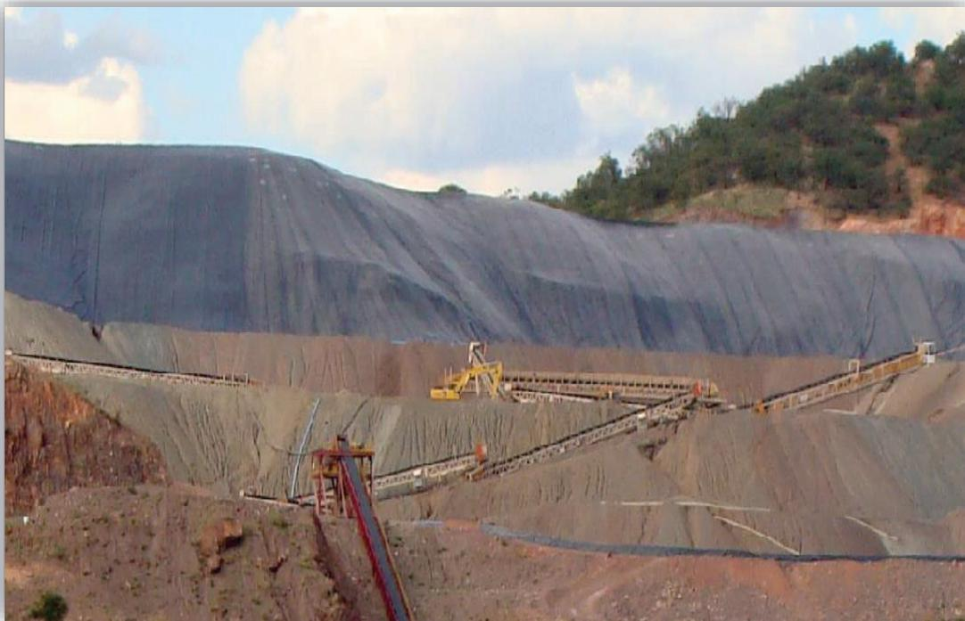
Foto 7.-Panorámica en donde se aprecia el relleno con mineral de los patios de lixiviación y el sistema de bandas para llevar el mineral a los patios.
