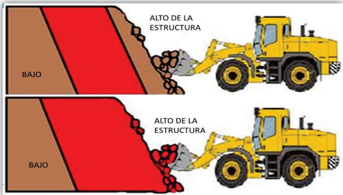
Figura 5.-En esta figura se puede observar la manera adecuada de llevar a cabo el rezagado de mineral y no entrar por la parte del bajo de la estructura (bajo) ya que de esta manera se contamina menos el mineral.
