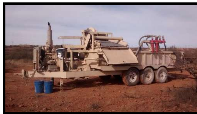
Figura 24. Maquinaria tipo rotaria empleada y bomba de lodos empleada para perforación de pozo TC-06.
