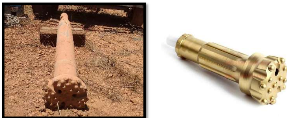
Figura 25. Martillo neumático empleado para la perforación de piezómetro MX-03.
