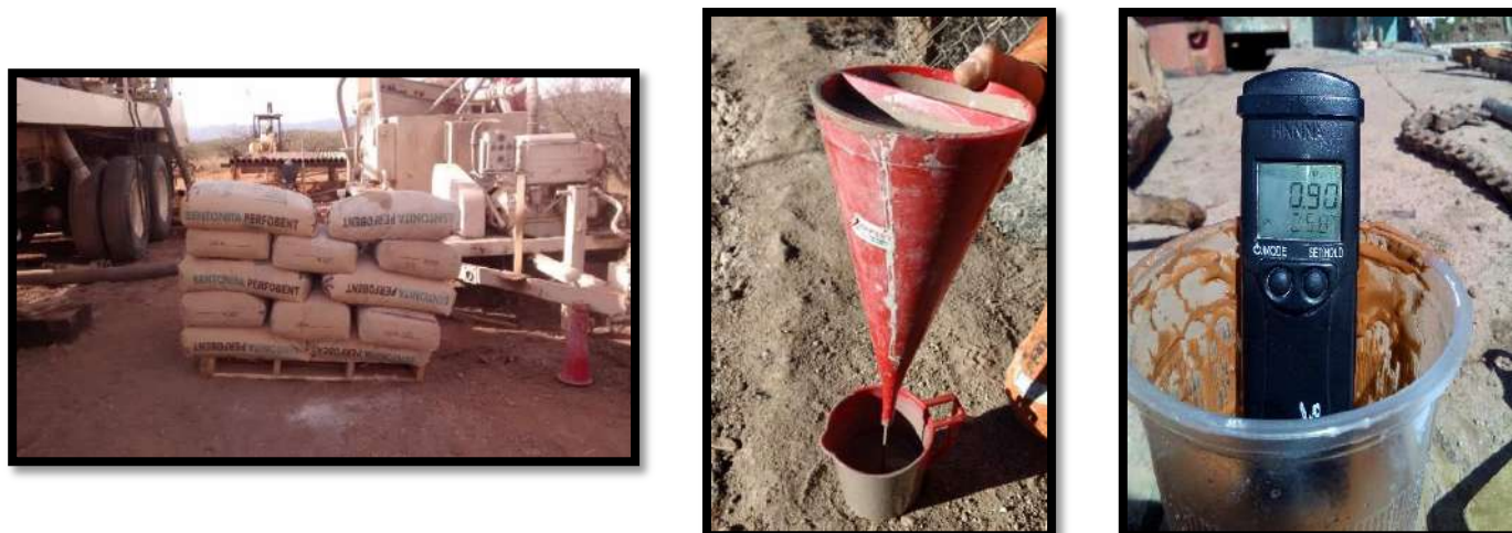
Figura 42. Sacos de bentonita (50 kg) empleados en la etapa exploratoria pozo TC-06 y medición de parámetros físicos.
