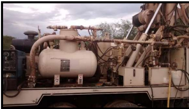
Figura 23. Compresor montado en GEFCO STAR 50K con 350 PSI.
