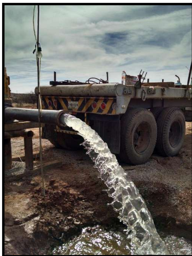
Figura 60. Prueba de aforo a caudal constante a 1600 RPM
