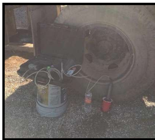
Figura 53. Multiparámetro empleado para la medición de pH, temperatura, C.E. y STD.
