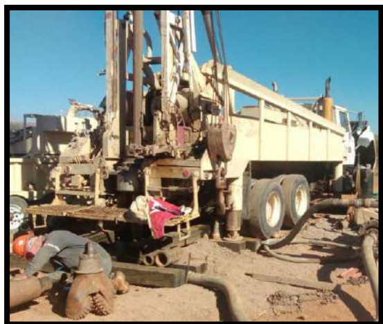
Figura 24. Maquinaria tipo rotaria empleada y bomba de lodos empleada para perforación de pozo TC-06.
