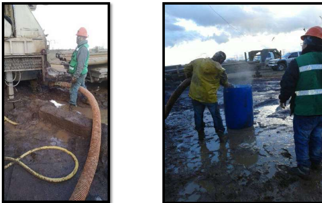
Figura 36. Medición del gasto en piezómetro MX-03.
