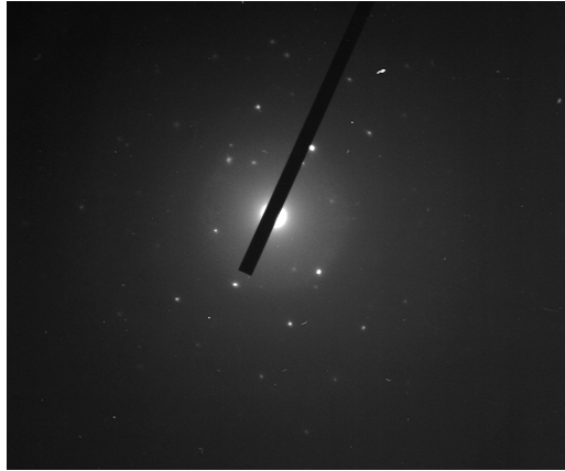
Fig. 5.3.4 Patrón de Laue producido por nanopartículas de PbSe alojado en zeolita natural
