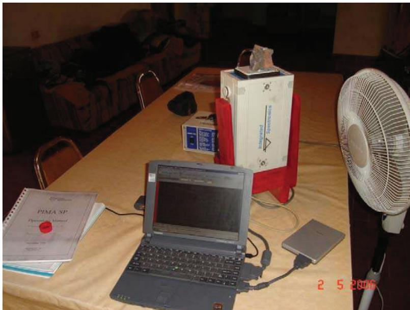
Foto 5.- PIMA II: consta de un espectrómetro, fuente de poder, computadora, cableado y soporte. Requiere de enfriamiento externo para trabajar adecuadamente.
