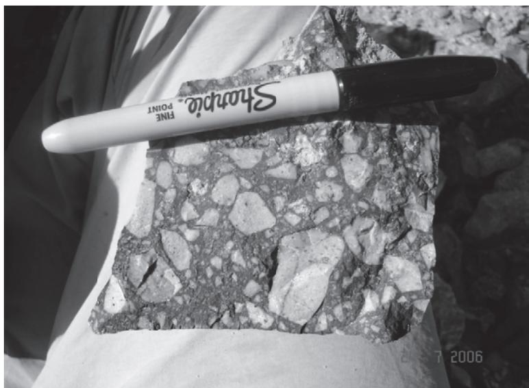
Foto 3.- Roca silicificada fuertemente brechada y cementada por sílice +hematita.
