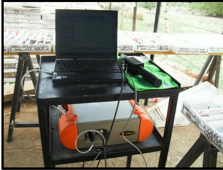
Figura 6. Equipo de reflectancia TerraSpec utilizado para la toma de datos espectrales del infrarrojo de onda corta (SWIR).
