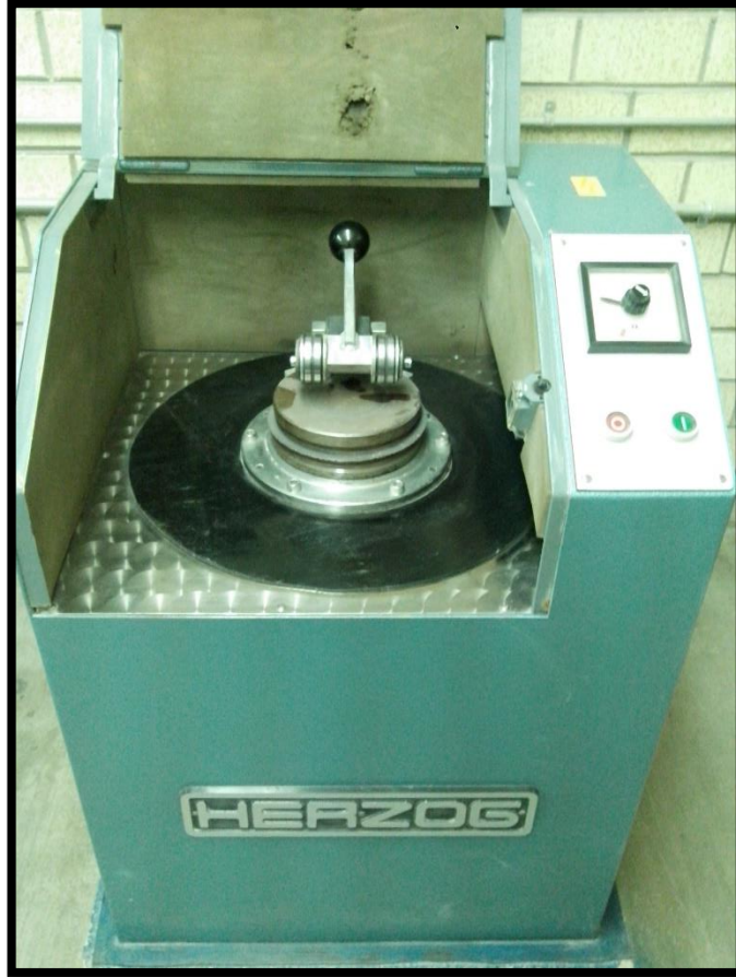
Figura 5. Molienda de carburo de tungsteno utilizada para la preparación de polvos para la difracción de rayos x.
