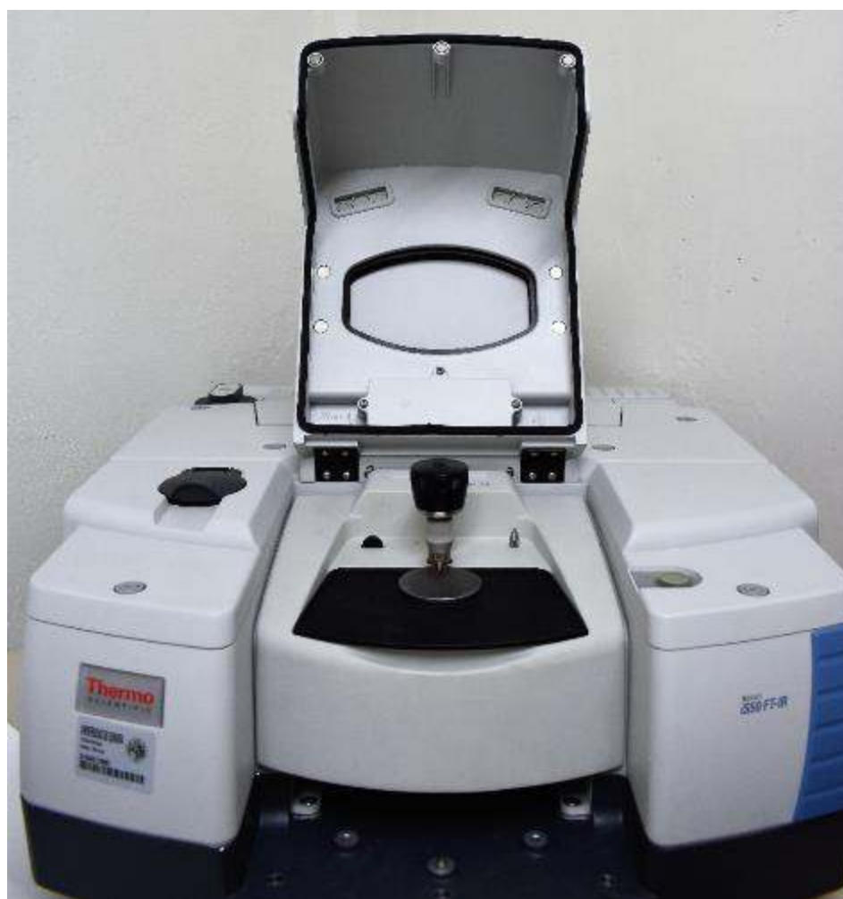
Figura 20. Espectrofotómetro Thermo Scientific Nicolet iS50.
