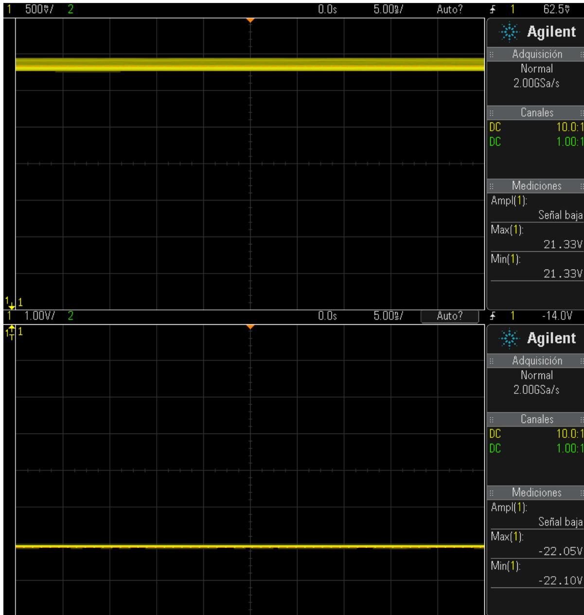
Figura 36 Voltajes rectificadas con capacitores de filtrado con 21.33 y -22.05 V.
