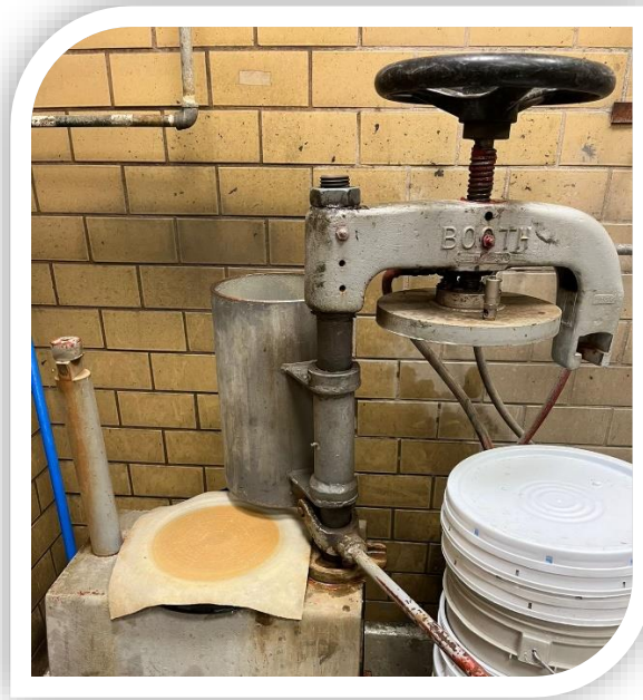
Figura. 20 Equipo de Filtración.
