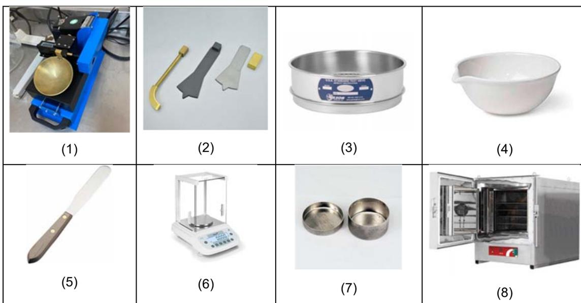
Figura 9. Material y equipo de laboratorio para la determinación del límite líquido
