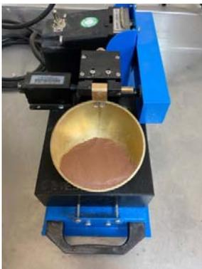
Figura 11. Muestra extendida en cuchara Casagrande
