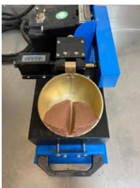
Figura 12. Muestra en cuchara Casagrande dividida
