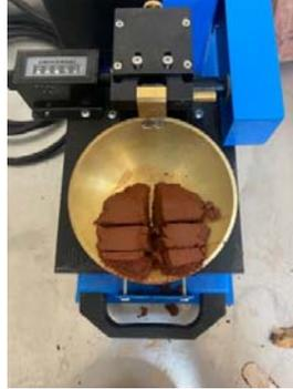
Figura 13. Porción de muestra tomada para pesar
