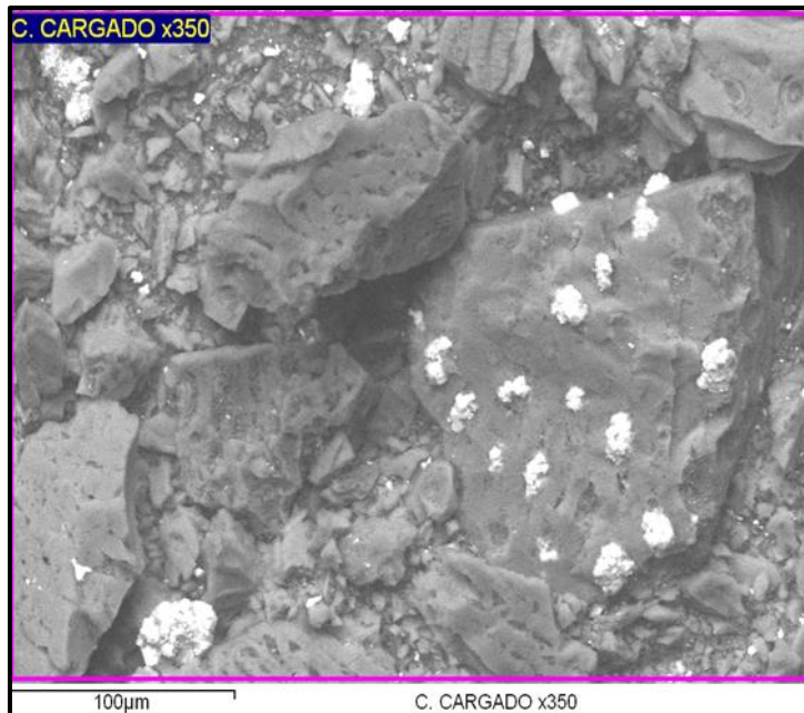
Figura 20. Micrografía Electrónica del carbón natural 6x10 cargado con oro a 500x
